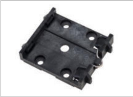
Um die korrekte Montage der SPS electronic Hochspannungsrelais zu gewährleisten wurde der Montageclip MC 22 entwickelt. Der aus robustem Kunststoff gefertigte Montageclip garantiert eine einfache und platzsparende Befestigung der Hochspannungsrelais RL 21, RL 42 und RL 42-I auf einer 35 mm Hutschiene. Für eventuell anfallende Wartungsarbeiten können die Montageclips ebenso einfach demontiert werden.
