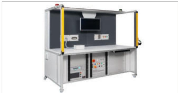
Prüfkäfig PK 6500A mit Lichtvorhang und versetztem Fußraum
